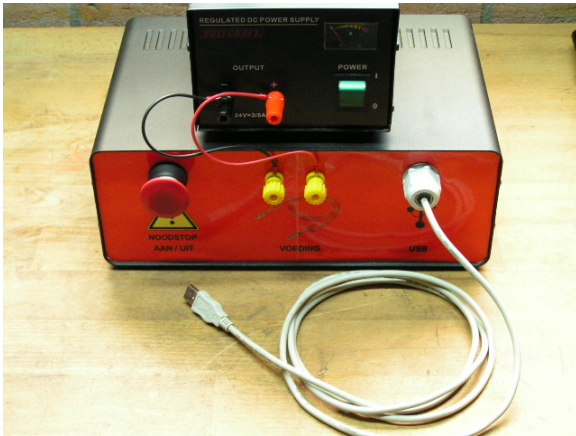
Foto links de besturing en de 24VDC voeding voor de motoren en het noodstop circuit. Het frontpaneel is gemaakt in "Front Designer", een programma van ABACOM
