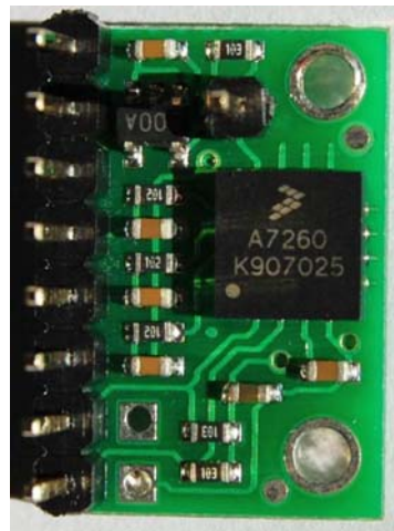
Figuur 3 : 3 assige versnellingsensor Freescale MMA7260
