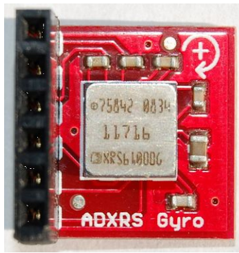
Figuur 2 : Gyro Analog Devices ADXRS 610
